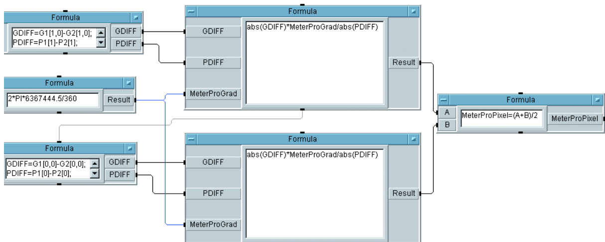
Abb. 10: Programmcode zur Ermittlung der Meter pro Pixel
